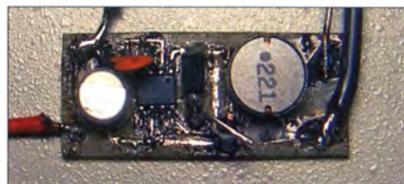
Bild 4: Die SMD-Variante ist gegenüber Bild 3 kleiner, jedoch ohne Gleichrichterbrücke.
