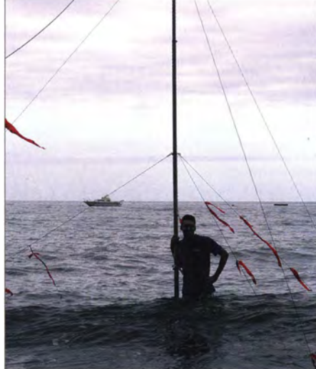
Eine der sorgfältig abgespannten Vertikalantennen direkt über Salzwasser
