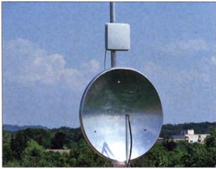
Bild 4: Das Mustergerät (oben) zusammen mit der 9-cm-Anlage von DL4SBK an einem 60-cm-Parabolspiegel beim Test
