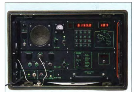
SE-430 – die letzte in der Schweiz entwickelte Armeefunkstation – mit 200 W, wählbar in den Stufen 2 W, 20 W sowie 200 W Foto: VBS
