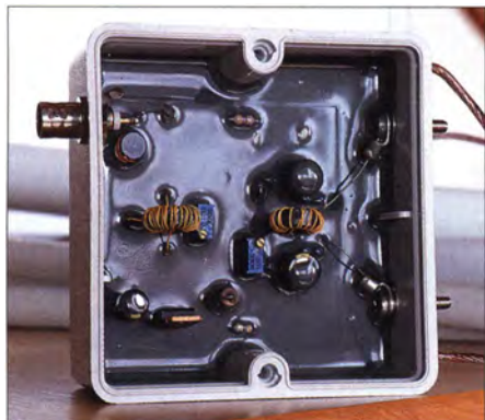
Bild 4: Innenansicht; ein Harz, das zusätzlich die Wärmeableitung vom Verstärker fördert, schützt die Elektronik. Links oben die BNC-Buchse fürs Koaxialkabel
