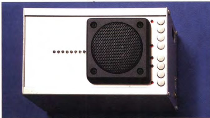
Bild 1: Außenansicht des Prototyps des Fledermausdetektors; das kommerzielle Gitter zum Schutz des Lautsprechers war gut gemeint, wirkt aber plump. Simple Durchbrüche in der Gehäuseoberseite hätten gereicht.
