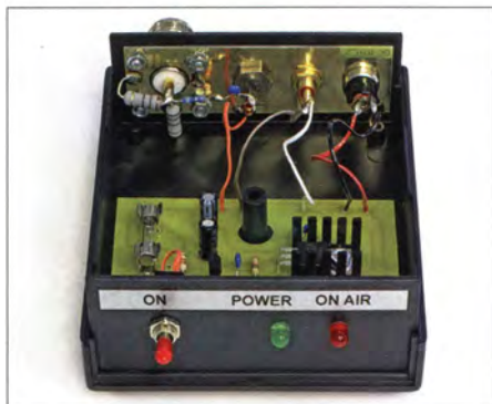
Bild 3: Fertige Steuereinheit; einige Bauelemente kommen freitragend an die Buchsen. Fotos: Red. FA (3), DL4SBK, OK2ER
