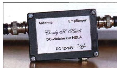
Bild 5: Die mitgelieferte Fernspeiseweiche versorgt den HDLA-Verstärker übers Koaxialkabel mit Strom.
