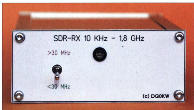
Bild 1: Musteraufbau des softwaredefinierten Breitbandempfängers Foto: DG0KW
