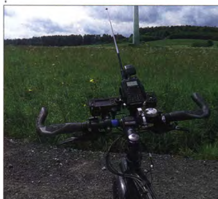
Mithilfe zusätzlicher Halterungen lassen sich die beiden Funkgeräte und das Navigationsgerät sicher am Lenker befestigen.
