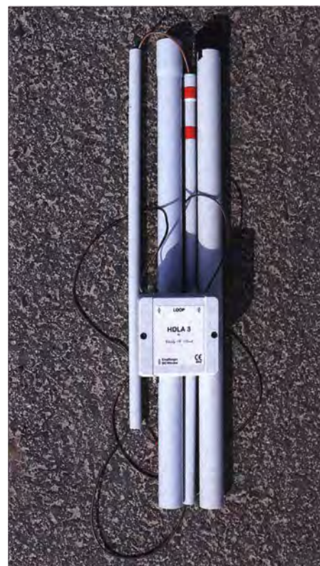
Bild 6: Zerlegt passt die HDLA problemlos in den Reisekoffer. Der Draht bleibt dabei mit dem Verstärker verbunden, sodass der Zusammenbau keine Minute dauert.
