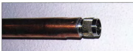
Bild 6: Anlöten des N-Steckers an das Kupferrohr nach Zusammendrücken des Endes
