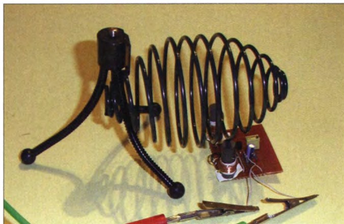
Bild 1: Bei diesem Stimmgabeloszillator wurde eine Feder verwendet, die sonst zur Aufnahme von fettreichem Vogelfutterballen dient. Andere, aus Eisen bestehende Gegenstände sind ebenfalls einsetzbar.
