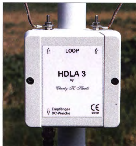
Bild 2: Ein wetterfestes Gehäuse schützt den Verstärker. Der Antennenanschluss (unten) benötigt draußen zusätzlichen Wetterschutz.
