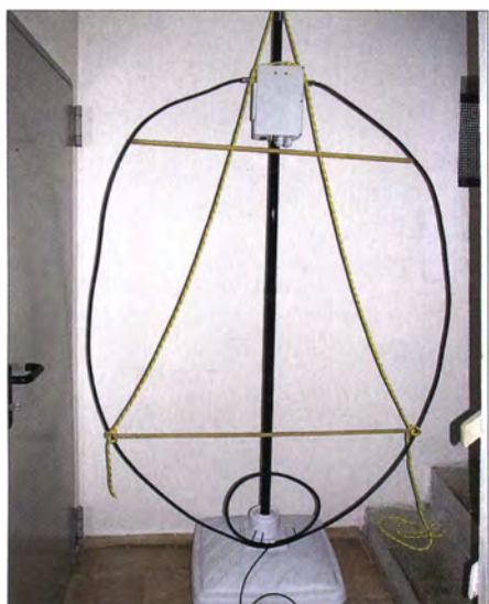
Bild 3: Aufbau mit H2000-Koaxialkabel auf einem Sonnenschirmständer
