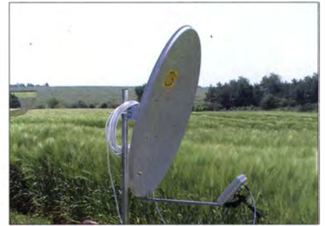
Bild 8: Die Planarantenne lässt sich zur Gewinnsteigerung als Erreger im Brennpunkt eines Offsetspiegels ( \varnothing 1,2 m empfohlen) einsetzen, der für terrestrische Funkverbindungen nach unten geneigt werden muss.
