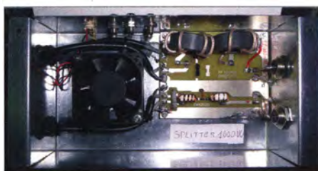
Einer von zwei Antennensplittern (hält 1 kW aus) für die Elecraft-KPA500-Endstufen
