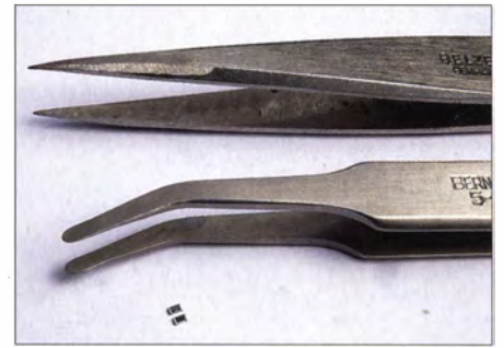
Bild 22: Diese beiden präzisen Pinzetten sind für SMD-Arbeiten gut verwendbar; im Vordergrund zwei Widerstände der Größe 0603 zum Vergleich.
