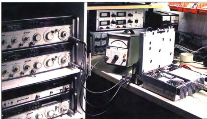
Bild 1: Messaufbau zur Phasenrauschmessung beim Autor; links die beiden Signalgeneratoren HP8640B, etwa in der Mitte das Effektivwert-Millivoltmeter HP3400 und darunter der Leistungssummierer
