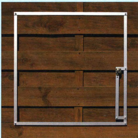
Bild 1: Der Musteraufbau der 2-m-Fensterscheibenantenne ist hier zu Versuchszwecken an einer hölzernen Trennwand im Garten angebracht.
