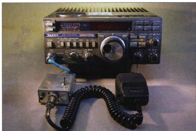
Bild 1: Der Musteraufbau der Abstimmhilfe ist in einem kleinen Kästchen untergebracht und in die Mikrofonleitung zum Yaesu FT-757 eingeschleift.
