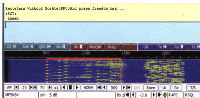
Bild 5: Zum Projekt gehören Experimente mit gleichzeitig zwei Digimodes in einem AM-Signal.
